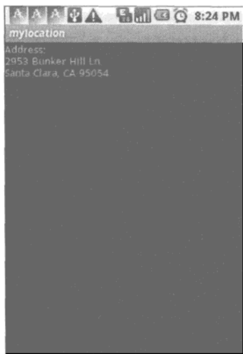
图10-2 反向地理编码示例，将经纬度坐标转换为地址
