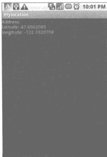
图10-3 地理编码示例，将包含地址的字符串解析为经纬度坐标
